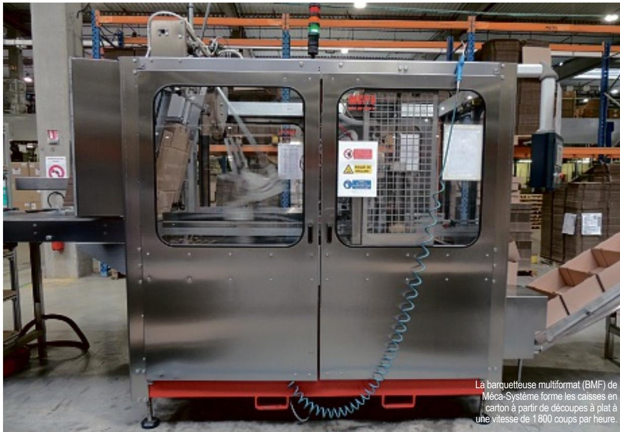
La barquetteuse multiformat (BMF) de Méca-Système forme les caisses en carton à partir de découpes à plat à une vitesse de 1 800 coups par heure.
